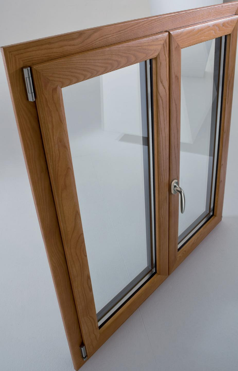
L'ABS raccorda il profilo in alluminio con quello in legno, riducendone la sezione. Le prestazioni termiche consentono così di realizzare infissi con vetrocamere convenzionali, anche per finestre di dimensioni ridotte, e quindi idonee a qualsiasi contesto di posa e richieste nelle ristrutturazioni residenziali o nei centri storici. Termalmix raggiunge comunque ottimi valori di trasmittanza termica, fino a **Uw 0,95**.
